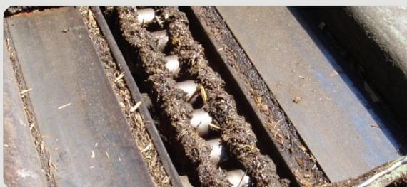
Una lubrificazione regolare e moderata è più efficace di una lubrificazione sporadica ed eccessiva. Tra perni, bussole e rulli si bisogna sempre una quantità sufficiente di lubrificante per ridurre l'usura, proteggere dalla corrosione e ridurre i rumori di funzionamento.
