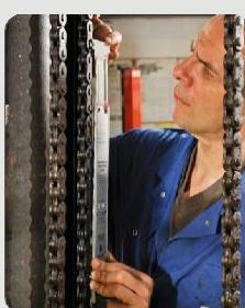
Le catene a rulli e flyer devono essere sostituite quando si sono allungate del 2-3%. A partire da questo valore di usura, infatti, non è più possibile garantire la sicurezza di funzionamento, poiché la resistenza alla fatica e la forza di rottura minima risultano fortemente ridotte.
