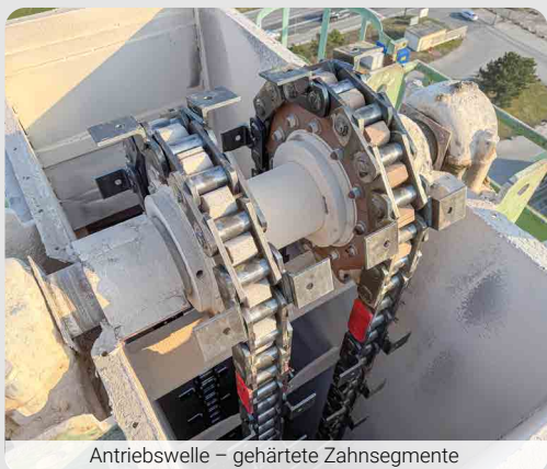
Antriebswelle – gehärtete Zahnsegmente
