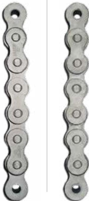
Le test au brouillard salin est un test standardisé pour l'évaluation de l'effet anticorrosion des revêtements métalliques ou des traitements de surface chimiques ou physiques. Les échantillons sont placés dans des conditions normalisées dans une chambre d'essai où une solution saline pulvérisée agit sur les chaînes.
