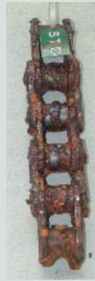
CR à l'état neuf CR après 500 heures Plaqués 360 heures Standard 360 heures Les valeurs de chaînes CR correspondent en terme de résistance à la corrosion des chaînes CRF.
