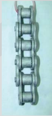
CR à l'état neuf CR après 500 heures Plaqués 360 heures Standard 360 heures Les valeurs de chaînes CR correspondent en terme de résistance à la corrosion des chaînes CRF.
