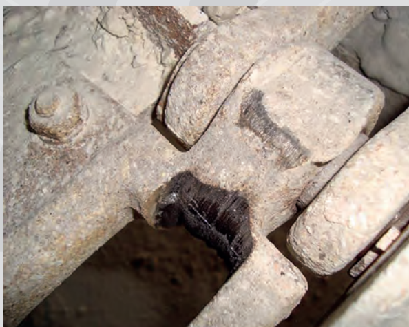
Starker Verschleiß durch Kettenrad
