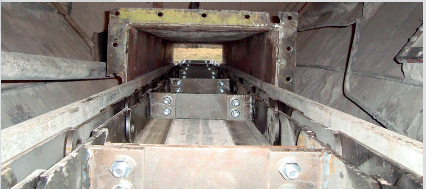
Optimierte FB-Buchsenförderkette in Bunkerabzugsförderer unter Kalksilo
