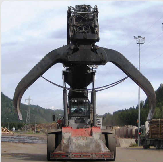
FB Niederhalterketten zur sicheren Fixierung der Stämme.
